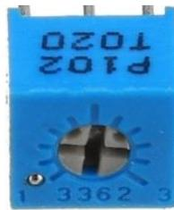
Рисунок 2 – Общий вид подстроечного резистора
